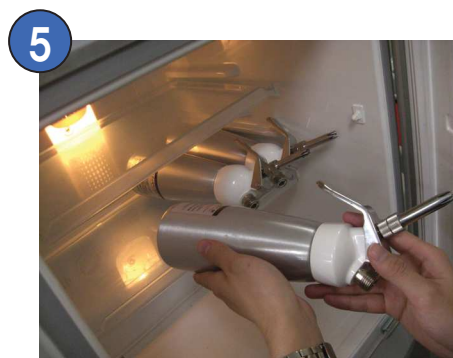
④流水ですすぎ、アルコール噴霧し、よく乾かしてから組み立てる。 水分の残ったボトルにアルコール噴霧する事で早く乾燥出来ます。
