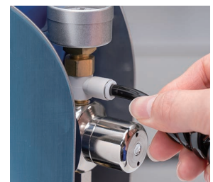
STEP4 新品のガス充填ホースを差し込む。ガス充填ホースを軽く引っ張り、抜けないことを確認する。
