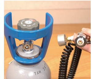
STEP4 圧力調整器を取り外す。
