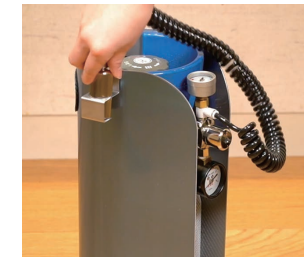
STEP7 ボンベをスタンドに収納する。
