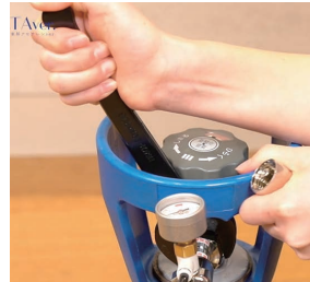
STEP3 専用スパナで圧力調整器の袋ナット部分を緩める。 ※この時ガスの抜ける音がします。
